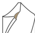
外圆刃尖破损 Corner fracture
