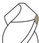
外圆刃尖破损 Corner fracture
